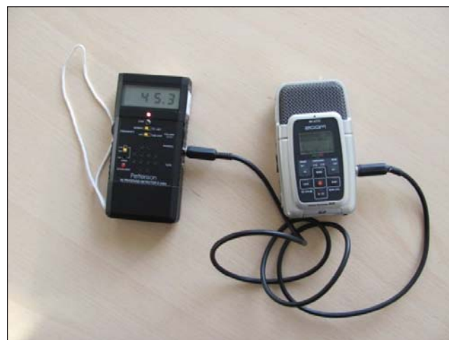
PETTERSSON D240X couplé à un enregistreur numérique
